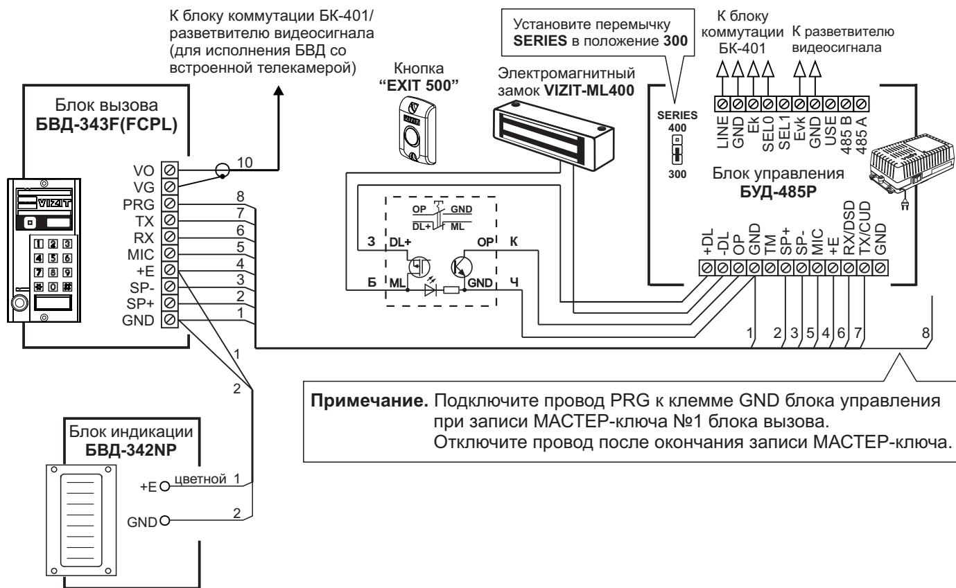
Рисунок 2 - Схема соединений блока вызова БВД-343F(FCPL) с блоком управления БУД-485P , блоком индикации БВД-342NP , электромагнитным замком VIZIT-ML400 и кнопкой EXIT 500
